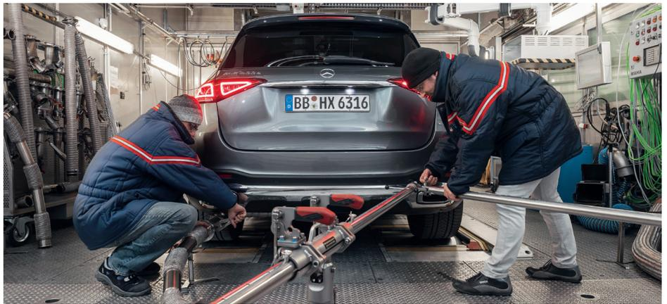
Die Emissionsmessungen sind seit Euro-6d-Temp nicht mehr nur auf dem Rollenprüfstand zu messen. Die Bestätigung der Werte auf der Strasse mit portablen Emissionsmesssystemen gehört zum Homologationsumfang. Foto: Mercedes
