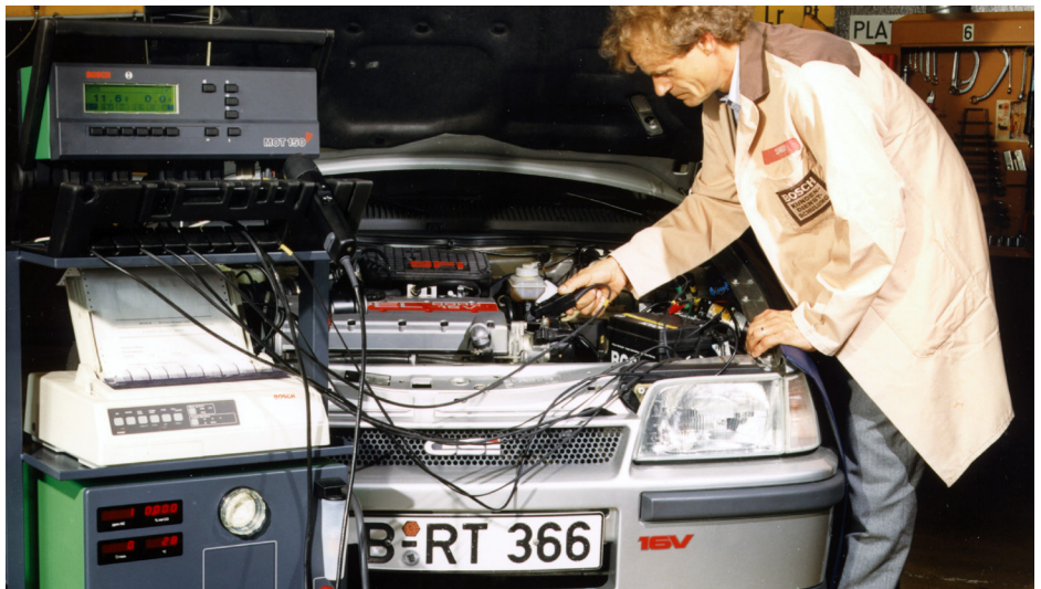
Bereits 1993 gehörte ein Motorentester (oben) und ein Abgastester (unten) zu den Diagnosetools in der Werkstatt und unterstützten die Werkstattprofis beim Fehler finden. Foto: Robert Bosch GmbH, Unternehmensarchiv
